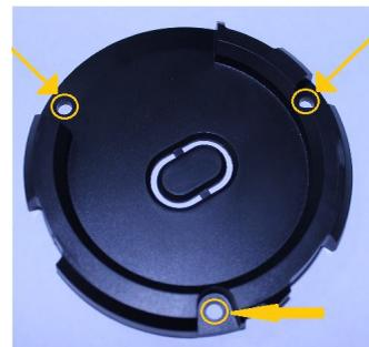
Корпус камеры в основном предназначен для крепежа на таких поверхностях, как армстронг, гипсокартон, подвесные потолки и т.п., в полостях которых будут пролегать кабели для подключения камеры. Поверхность должна быть предварительно подготовлена для крепежа и прокладки кабелей.
